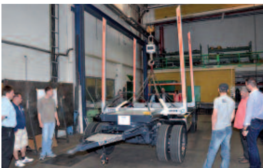
Oben: Die Waage liefert den Beweis: Der neue zwillingsbereifte Kurzholzanhänger wiegt nur rund 2,4 Tonnen.
