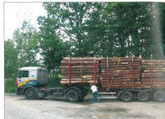
**Abb. 6 u. 7:** Der abgesattelte Auflieger wird am Übergabepplatz am Waldrand von einem Straßenfahrzeug ohne Allradantrieb und ohne Kran abgeholt. Ein solches Zugfahrzeug ist kostengünstig, ist nach Verschleiß leicht zu ersetzen und ermöglicht – zusammen mit der Tiefladerbauweise des Sattelaufliers – eine hohe Nutzlast, die Huttner mit ca. 28 t angibt. Zudem muss der Fahrer Offroad- und keine Kranführer-Erfahrung haben.
