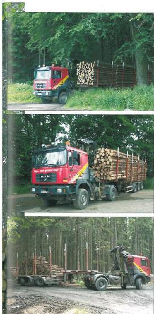
Abb. 1–4: Der Auflieger SART-39/3 wird im Wald von einer geländegängigen Allrad-Sattelzugmaschine mit dem Ladekran Loglift 215 Z beladen. Die Sattelkupplung ist hydraulisch um 1,2 m verschiebbar, um den hinteren Stoß laden zu können.
