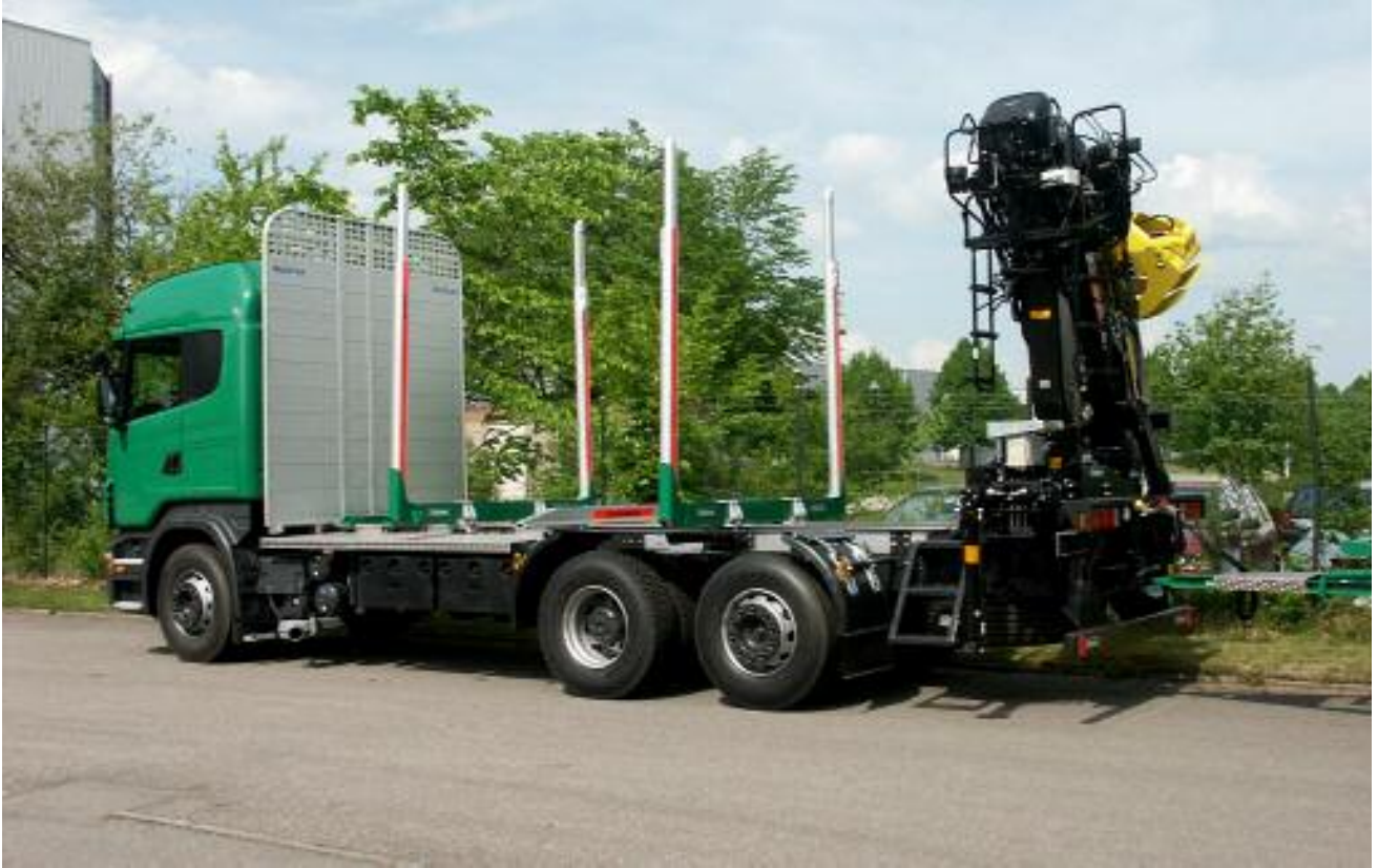
Aufbau mit ALUCAR Aluminium Hilfsrahmen und Schutzwand
