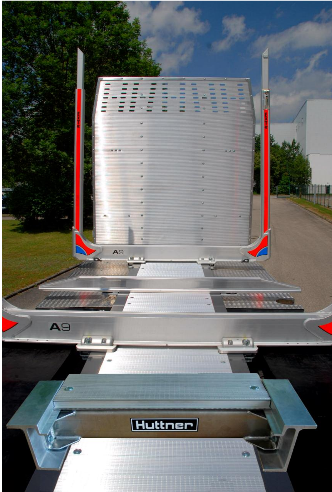
Boden belegt mit geriffeltem Alu-Bodenprofil - versenkt montiert
