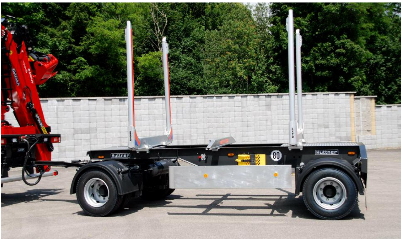
Anhänger Typ N2SZ-18/LB (Zwillingsbereift auf Stahlfelgen) 2.580 kg
