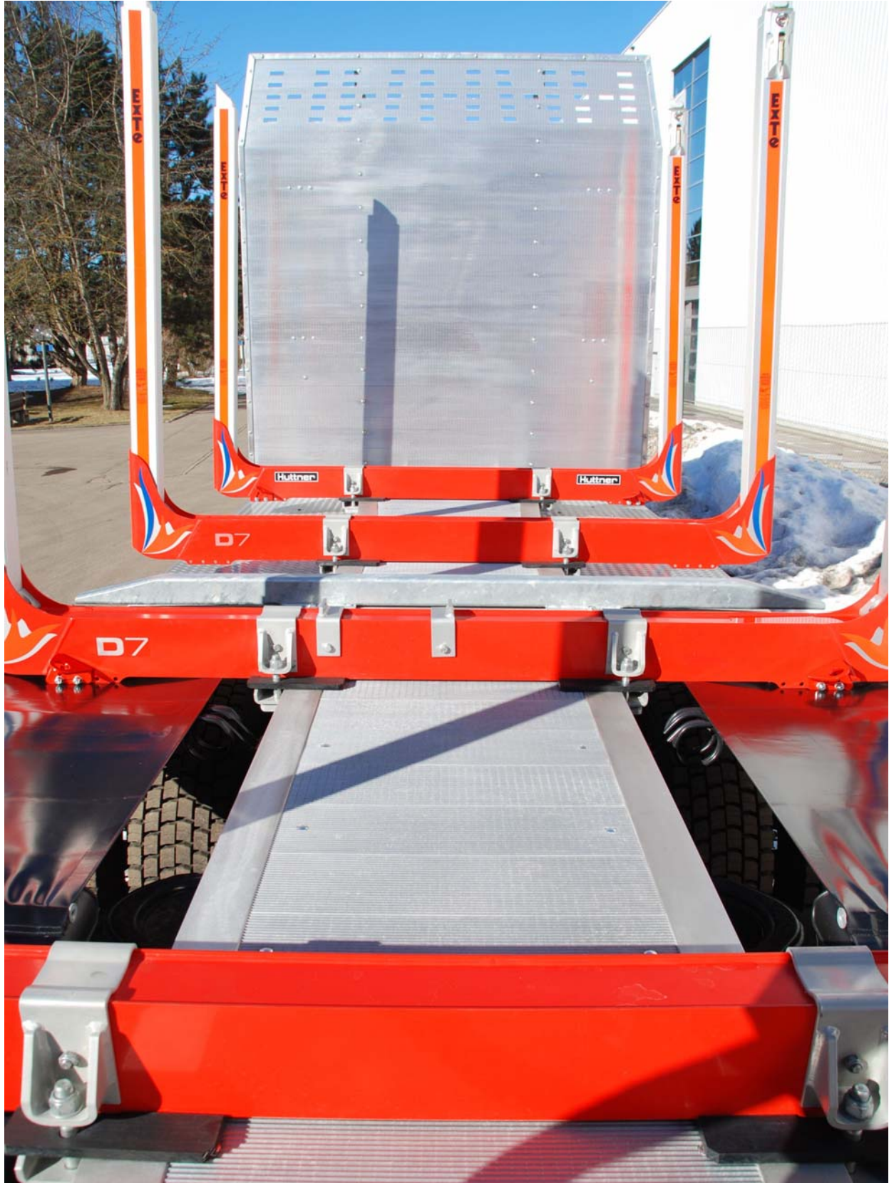
Boden belegt mit geriffeltem Alu-Bodenprofil - versenkt montiert
