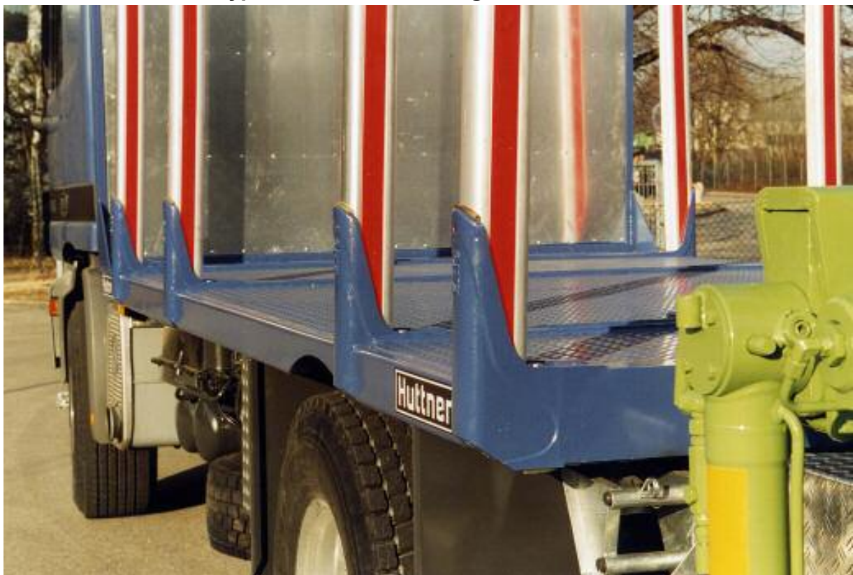
ExTe Ladeschemel Typ E in der Brücke eingeschweißt
