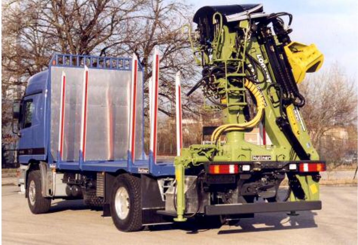
ExTe Ladeschemel Typ E in der Brücke eingeschweißt
