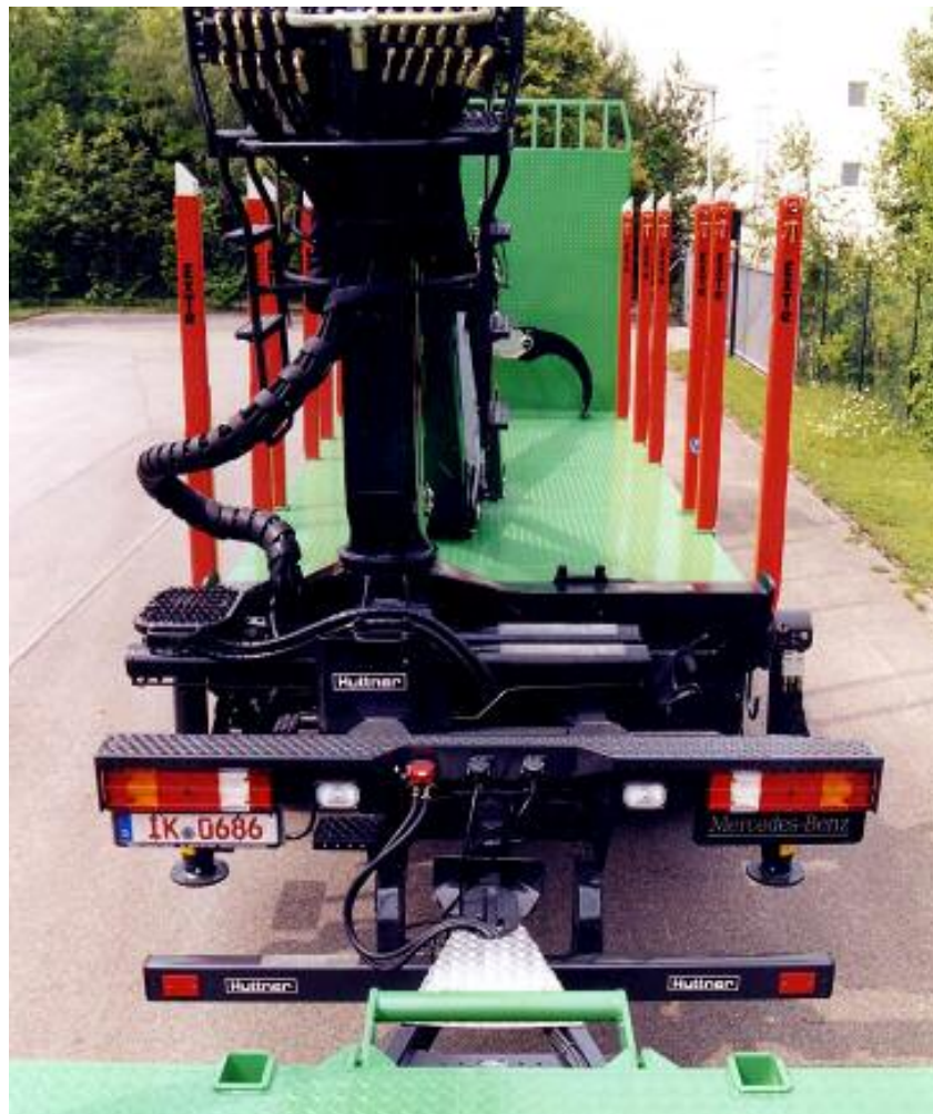
Stahladebrücke - Schemeinteilung frei wählbar
