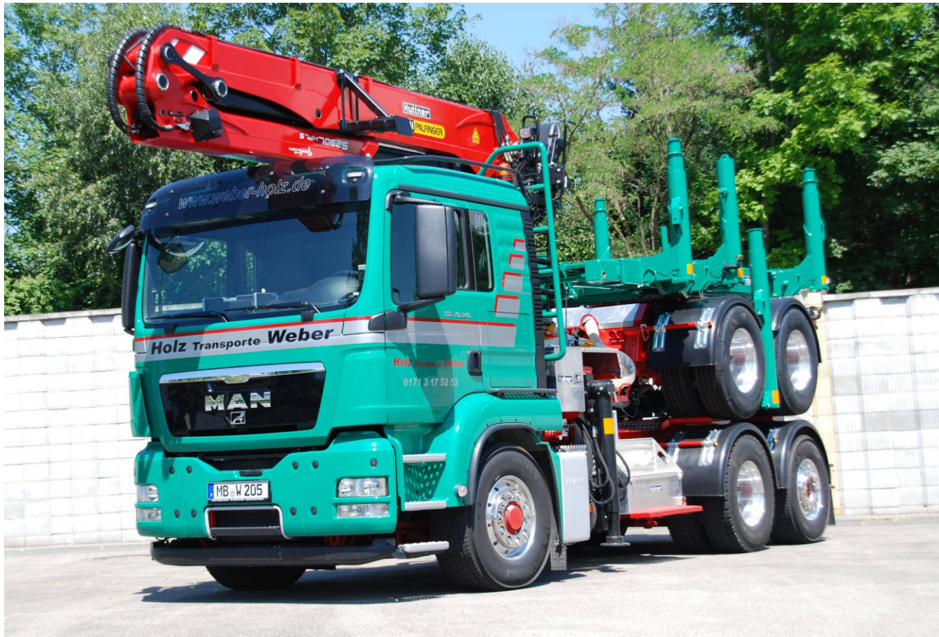
auf MAN TGS 26.540 6x4H-2BL (Hydrodrive) mit EPSILON Ladekran Typ S290L-87 HPLS
