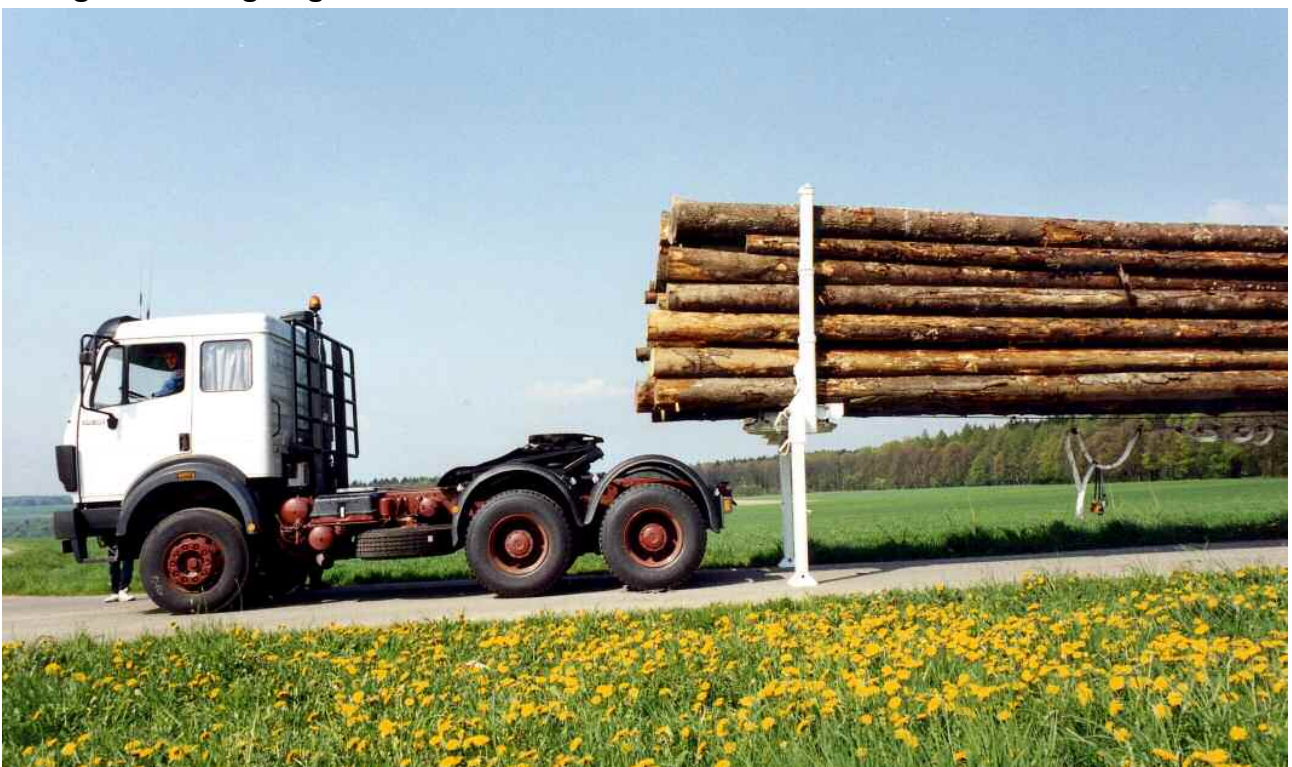
Ladefahrzeug mit liftbarer Sattelkupplung oder Luftfederung mit Heben- und Senken Einrichtung
