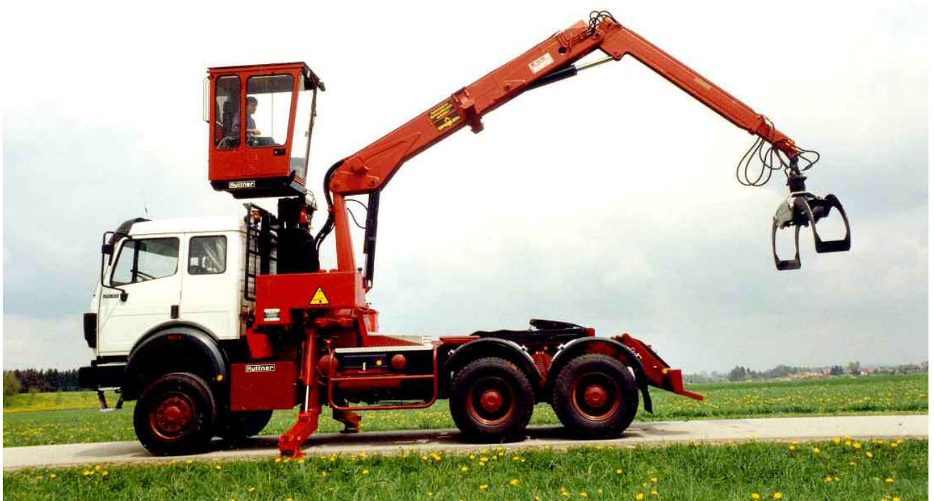
Steuerkabine getrennt vom Kran und hydraulisch hochfahrbar
