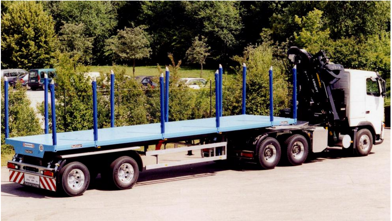
Sattelaufliieger mit Stahlpritsche aus 4mm Riffelblech
