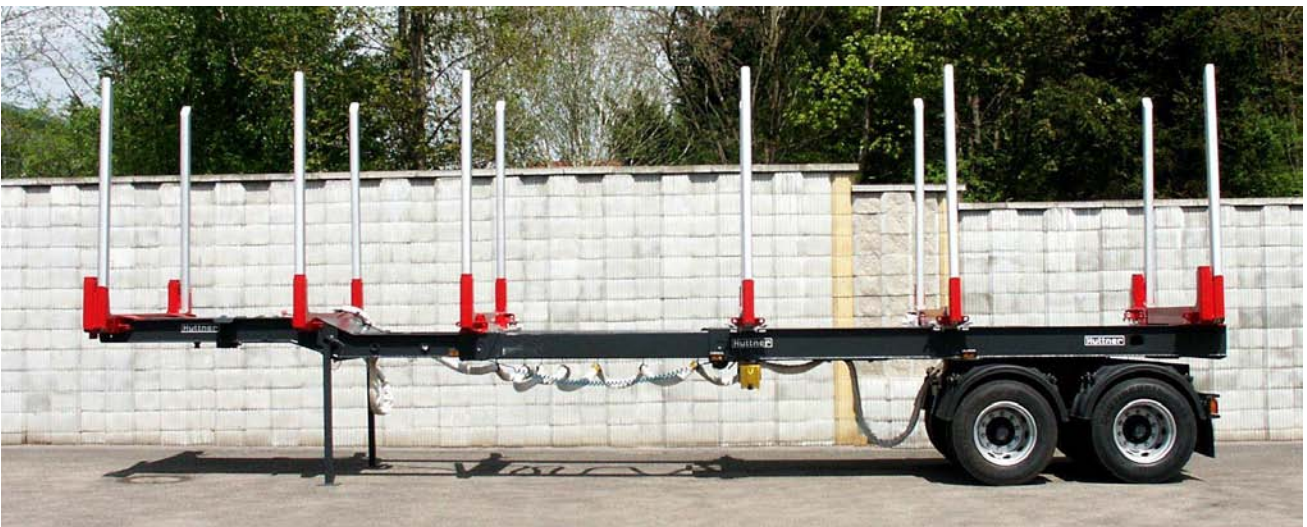
Ausgezogen zum KH-Transport - hier für 3x 4m
