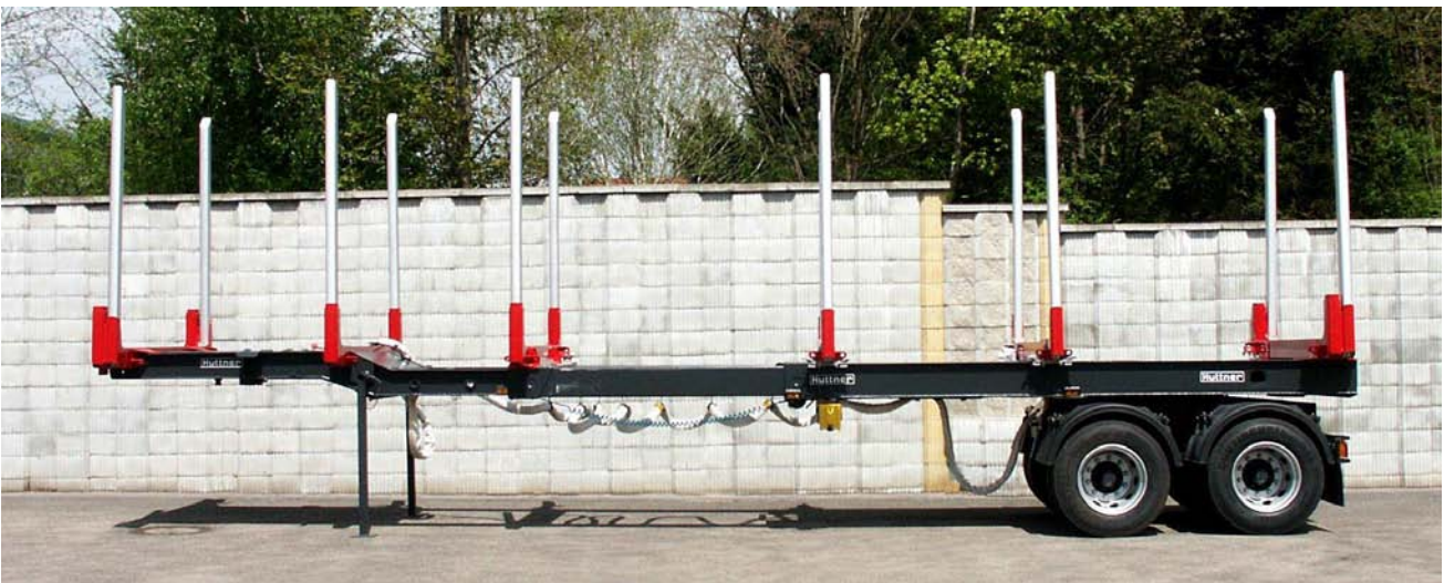
Ausgezogen zum KH-Transport - hier für 3x 4m
