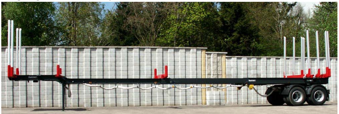
Doppelteleskop kpl. Ausgezogen zum LH-Transport bis 22m
