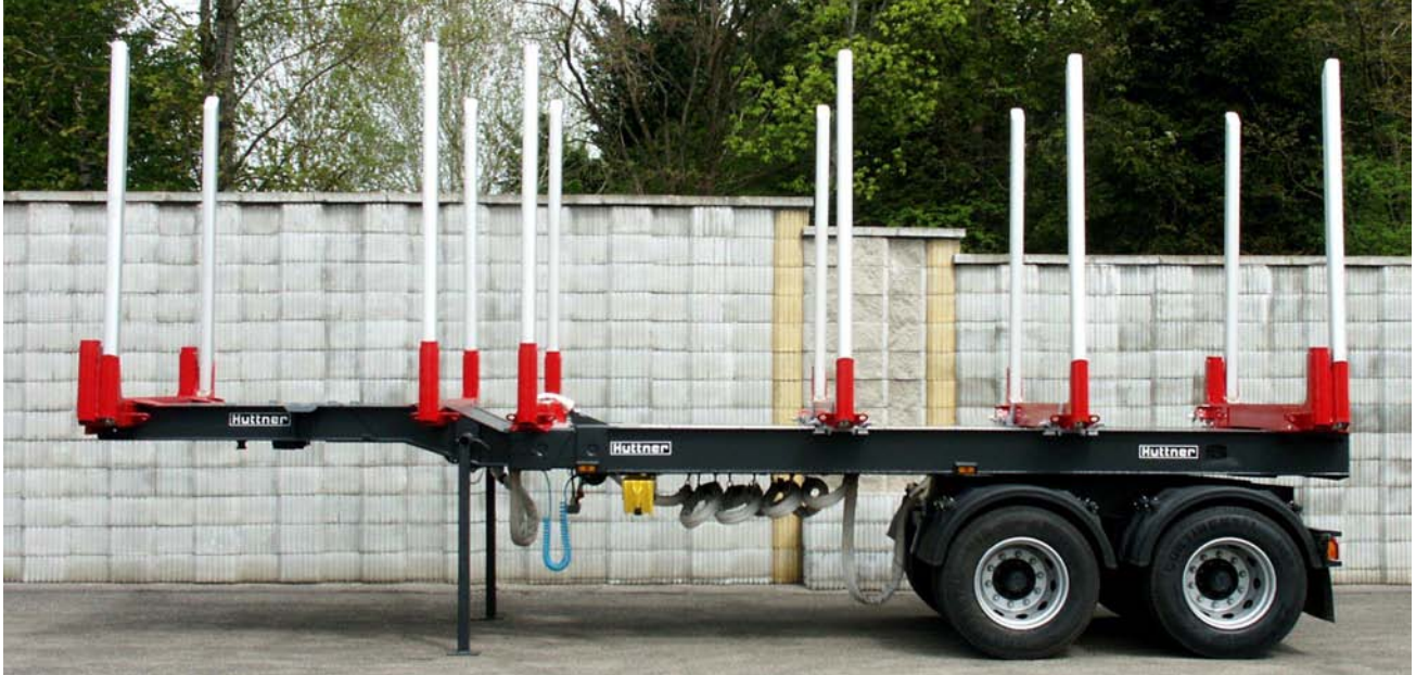
Zusammengeschoben für Leerfahrt und Ladestellung
