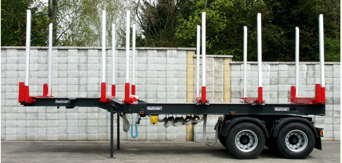
Zusammengeschoben für Leerfahrt und Ladestellung
