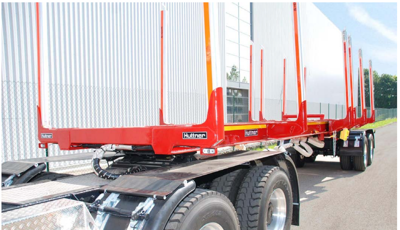
Mit hydraulischer Zwangslenkung auf die komplette Doppelachse wirkend
