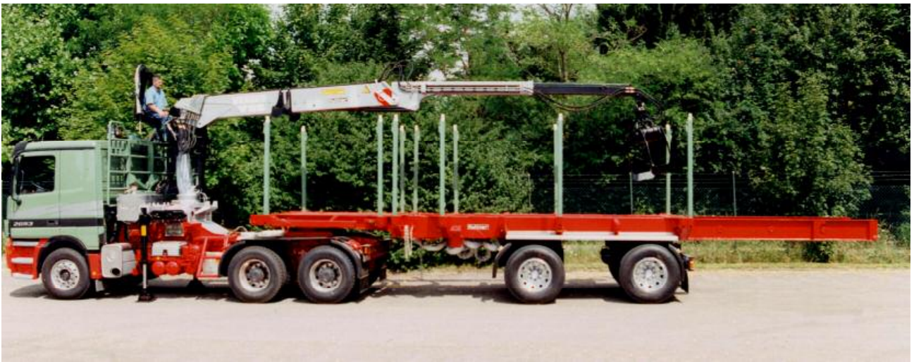
Aufleger zusammengeschoben – Ladeposition für hinteren Stoß
