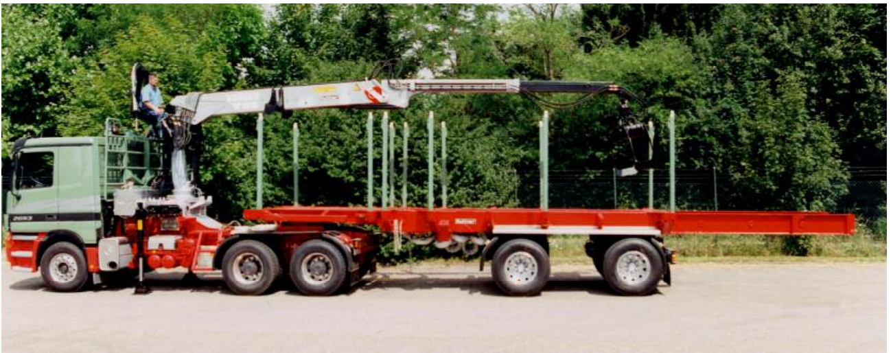
Aufleger zusammengeschoben – Ladeposition für hinteren Stoß
