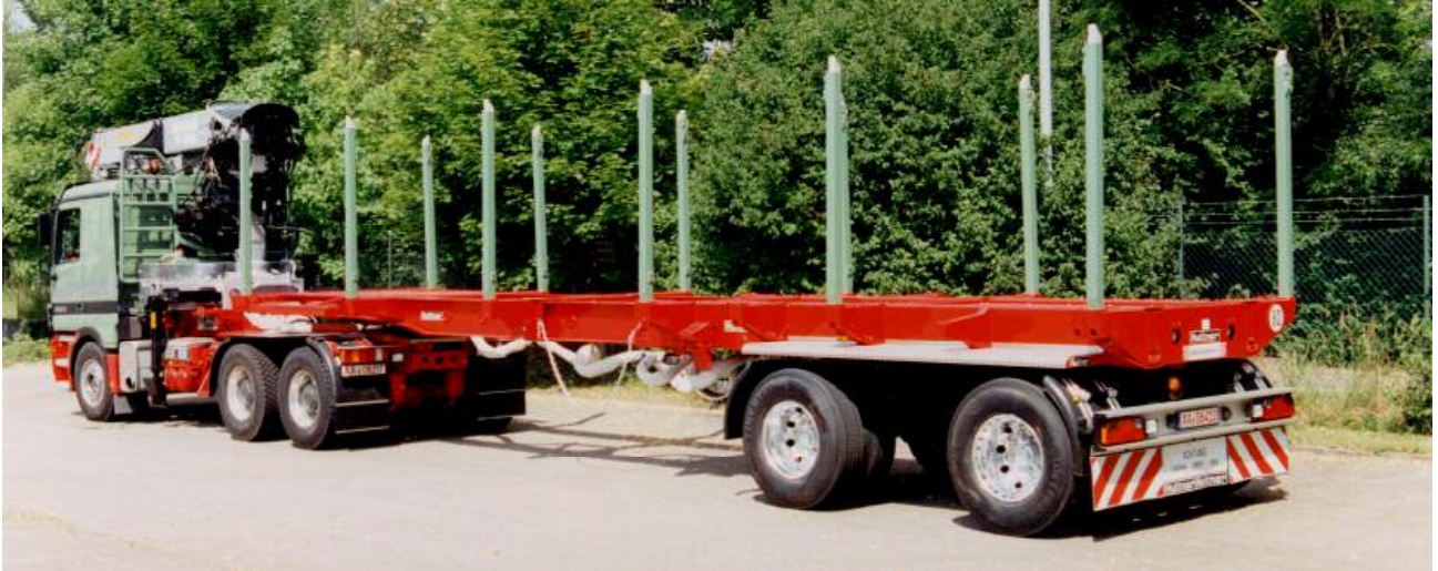
Ladeschemel versenkt eingeschweißt, nieder und leicht
