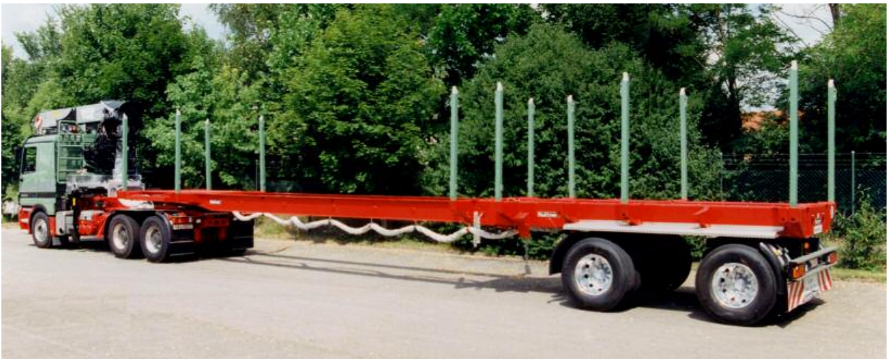
Aufleger ausgezogen zum Transport von Langholz bis max. 20,5 m Länge
