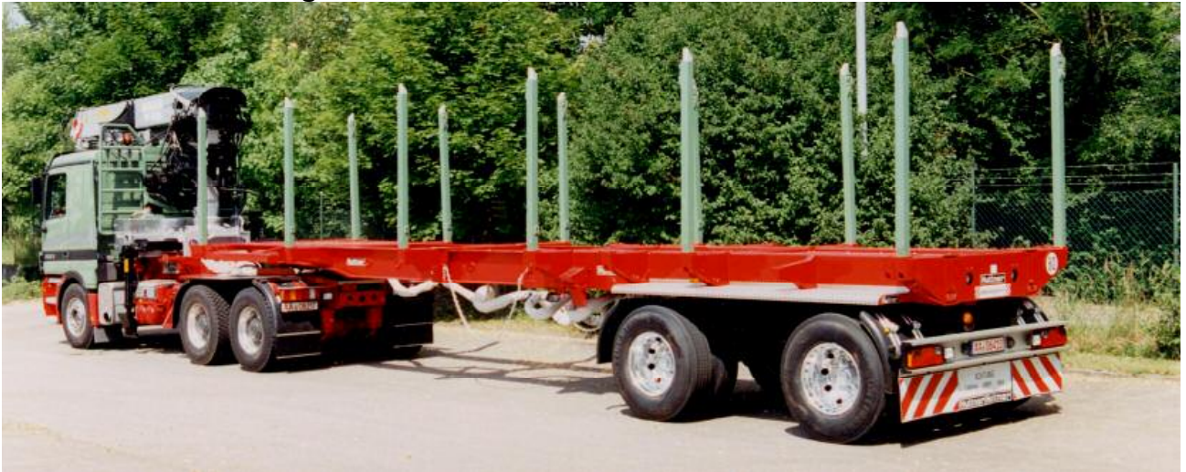
Ladeschemel versenkt eingeschweißst, nieder und leicht
