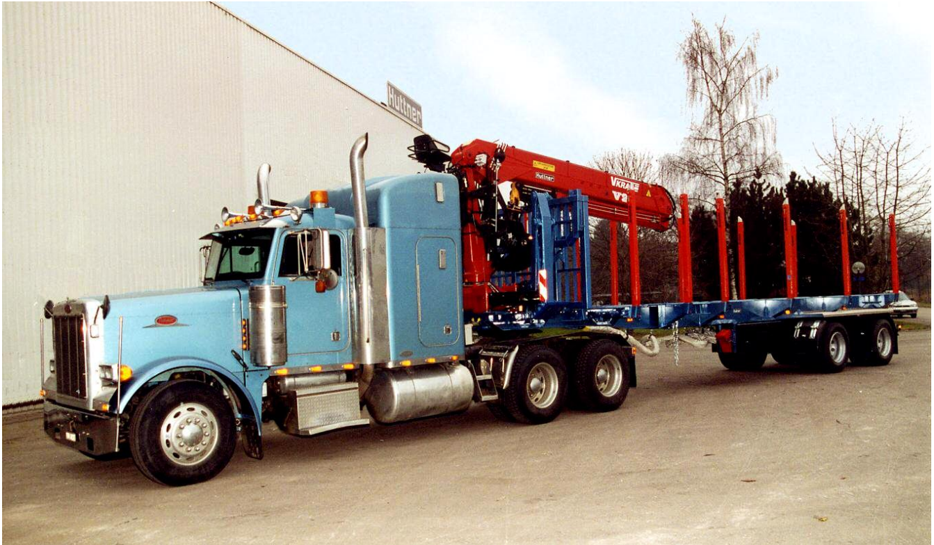
Sattelaufleger ausziehbar mit 24 mto. Ladekran auf Sattel montiert
