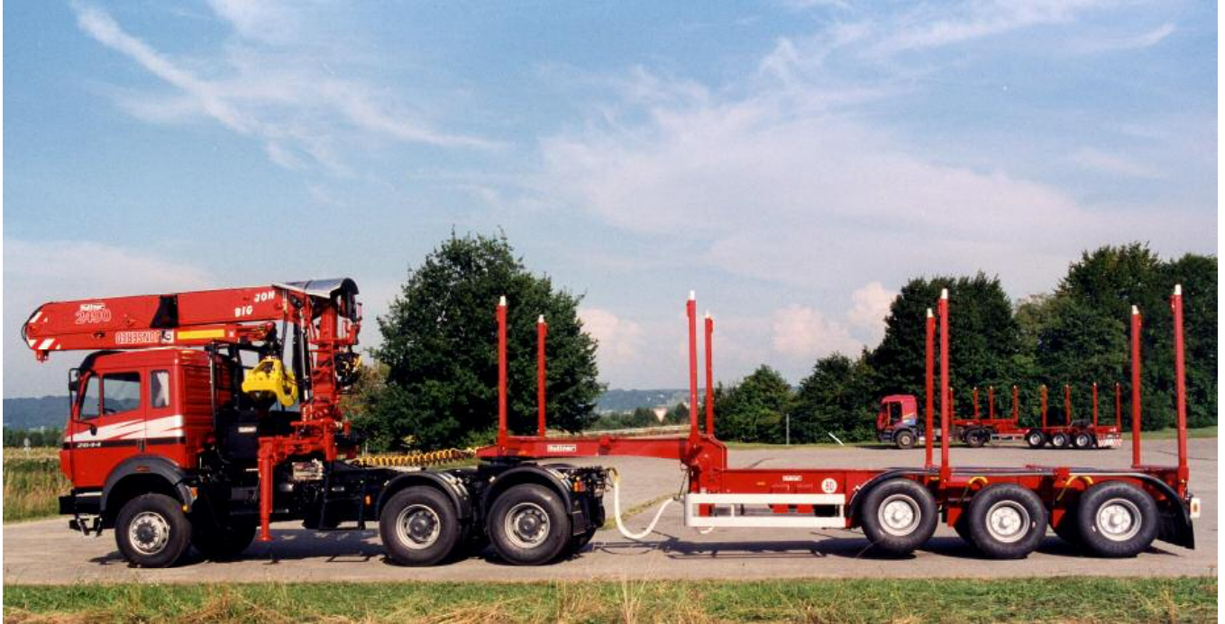
Ladefahrzeug mit Zugmaschine (6x6), verschiebbarer Sattelkupplung und Ladekran
