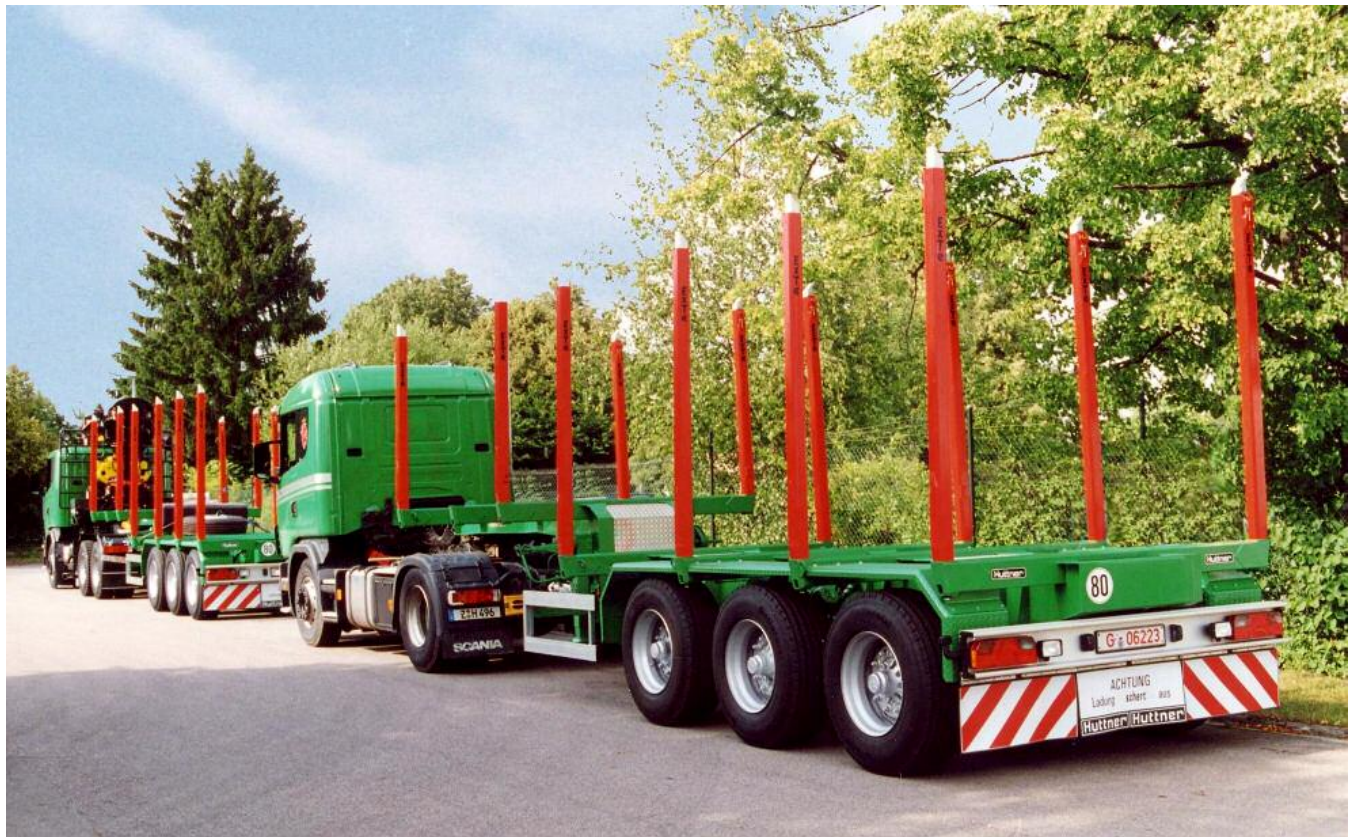
Transportfahrzeug mit LKW (4x2) ohne Ladekran (komplett ab 12.000 kg Eigengewicht)
