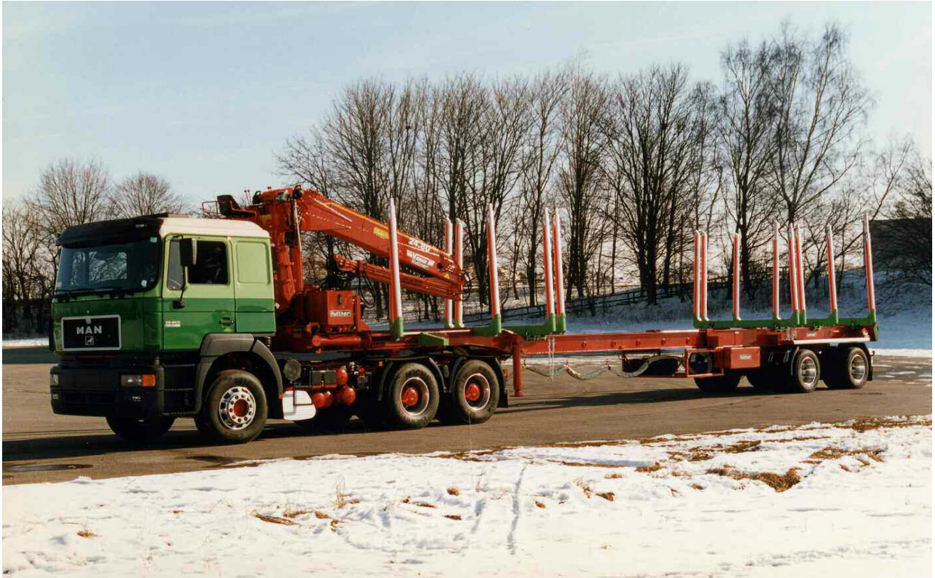
Sattelaufleger 6m ausziehbar mit 24 mto. Ladekran auf Sattel montiert
