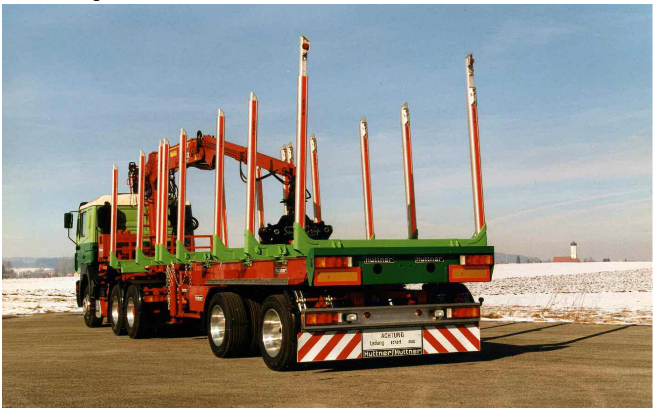
Sattelaufleger 6m ausziehbar mit 24 mto. Ladekran auf Sattel montiert
