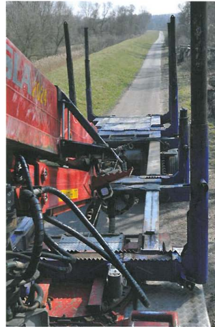
Oben und links: Durch die Vielseitigkeit der Kombibrücke ist auch der Holztransporteur vielseitig und dadurch sehr wettbewerbsfähig. Das Gewicht der Ladung wird durch eine Kranwaage ermittelt und auf einem Display angezeigt (oben).
