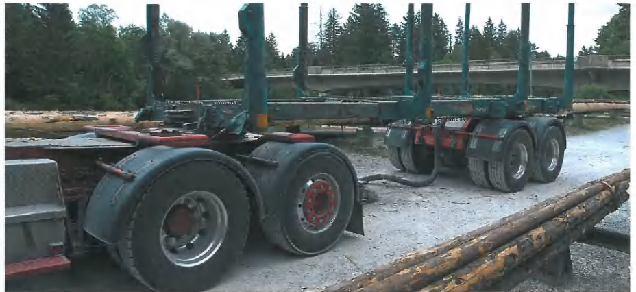
Wird die Huttner-Kombibrücke auseinandergezogen, kann Kurzholz transportiert werden.
