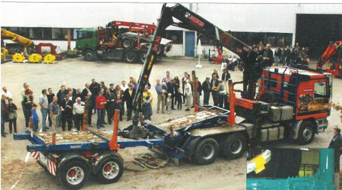
Abb. 1: Ein buntes Völkchen ließ sich am 11. Oktober in Landsberg/Lech die Funktionsweise von Huttners neuem Kombizug zeigen. Hier der entscheidende Moment: Der Verbindungsrahmen wird von unten in die Halterungen eingeklinkt und mit Bolzen verriegelt.
