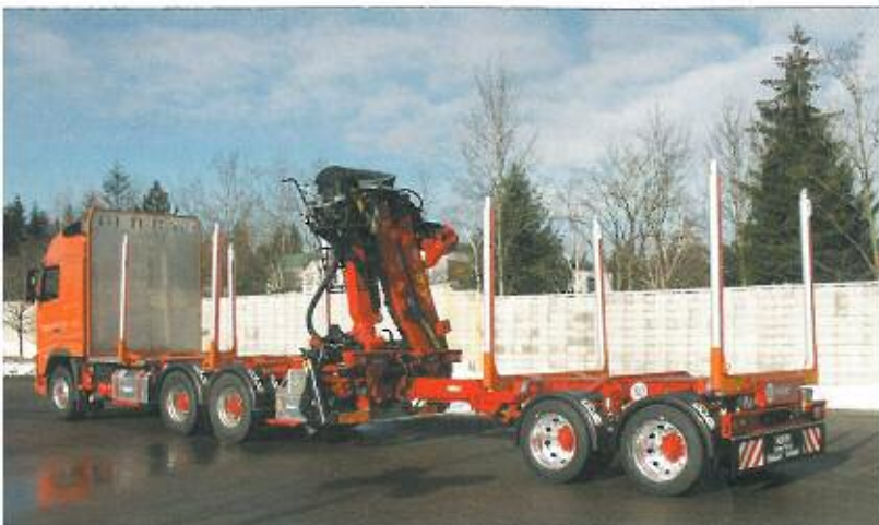
Abb. 4, oben links: Ein einfacher, robuster Sattelaufleger zum Buchentransport mit dem neuen Loglift-Kran F 2815. Der Lkw ist ein MAN-TGA 26.480 (6x4).
