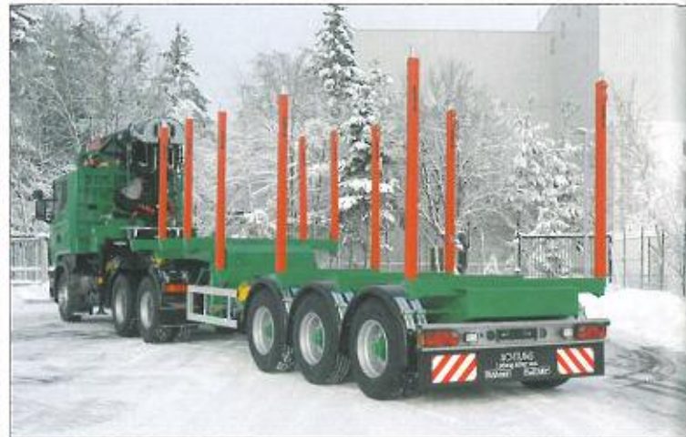
Abb. 4, oben links: Ein einfacher, robuster Sattelaufleger zum Buchentransport mit dem neuen Loglift-Kran F 2815. Der Lkw ist ein MAN-TGA 26.480 (6x4).
