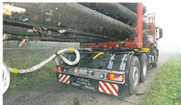
lenksystem die Geberzylinder im Aufbau-rahmen. So lässt sich der Nachläufer über eine Protzvorrichtung aufsatteln, was den Ladekran stark entlastet. Diese Konstruktion ermöglicht nun auch Brücken für 3×4 m. Toni Schmucki hat jedoch die Leichtbauausführung für zwei Stöße Holz ohne Protzvorrichtung gewählt. Ein weiterer Unterschied ist, dass er so die Brücke samt mittleren Schemeln zur Gewichtsreduzierung bei längerem Einsatz nur im Langholztransport herausnehmen kann.
