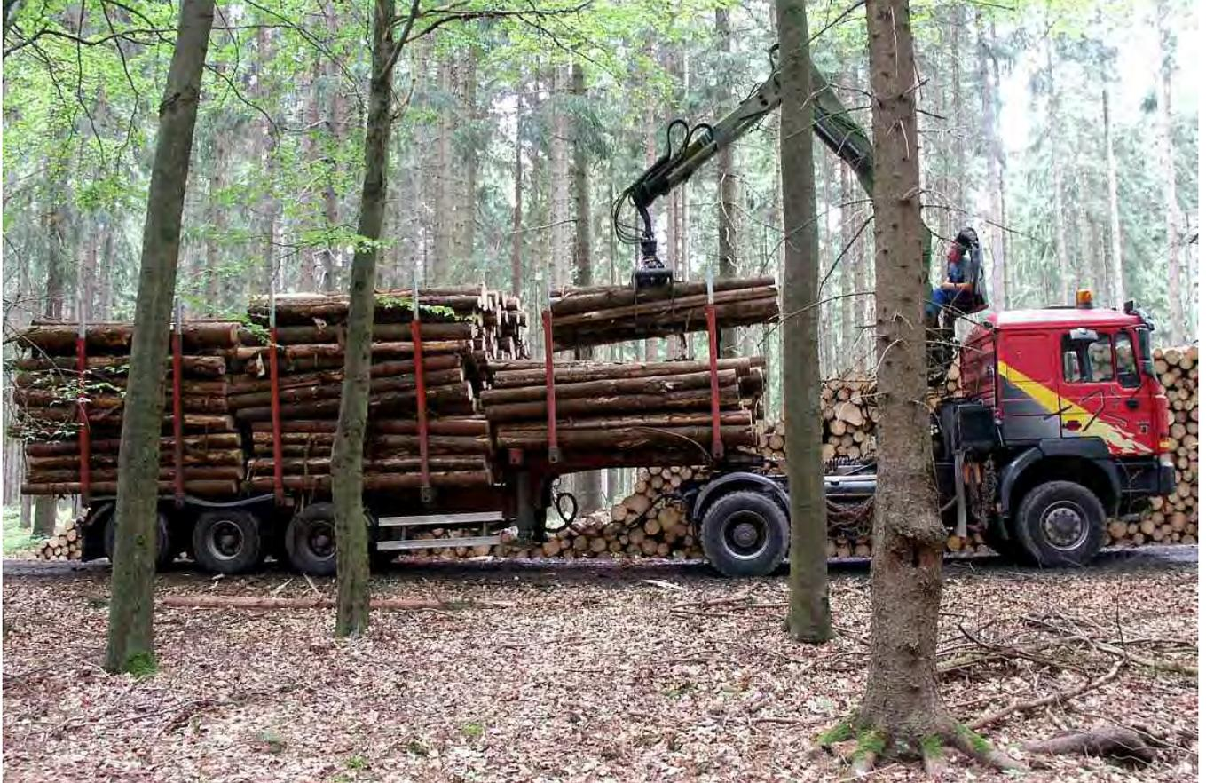
**Sattelkupplung wieder in Fahrstellung – der vordere Stapel wird geladen**
