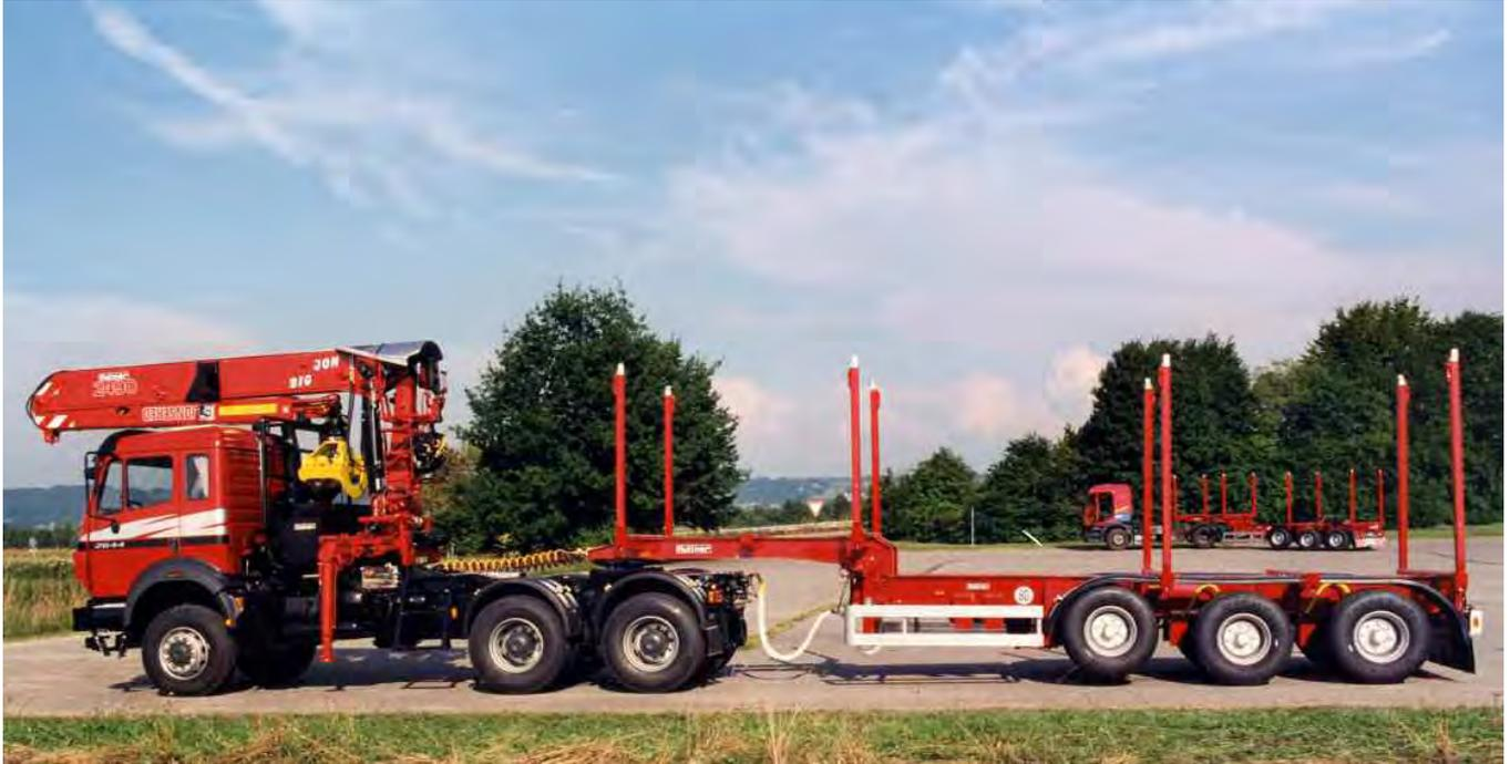
**Ladefahrzeug mit Zugmaschine (6x6), verschiebbarer Sattelkupplung und Ladekran**
