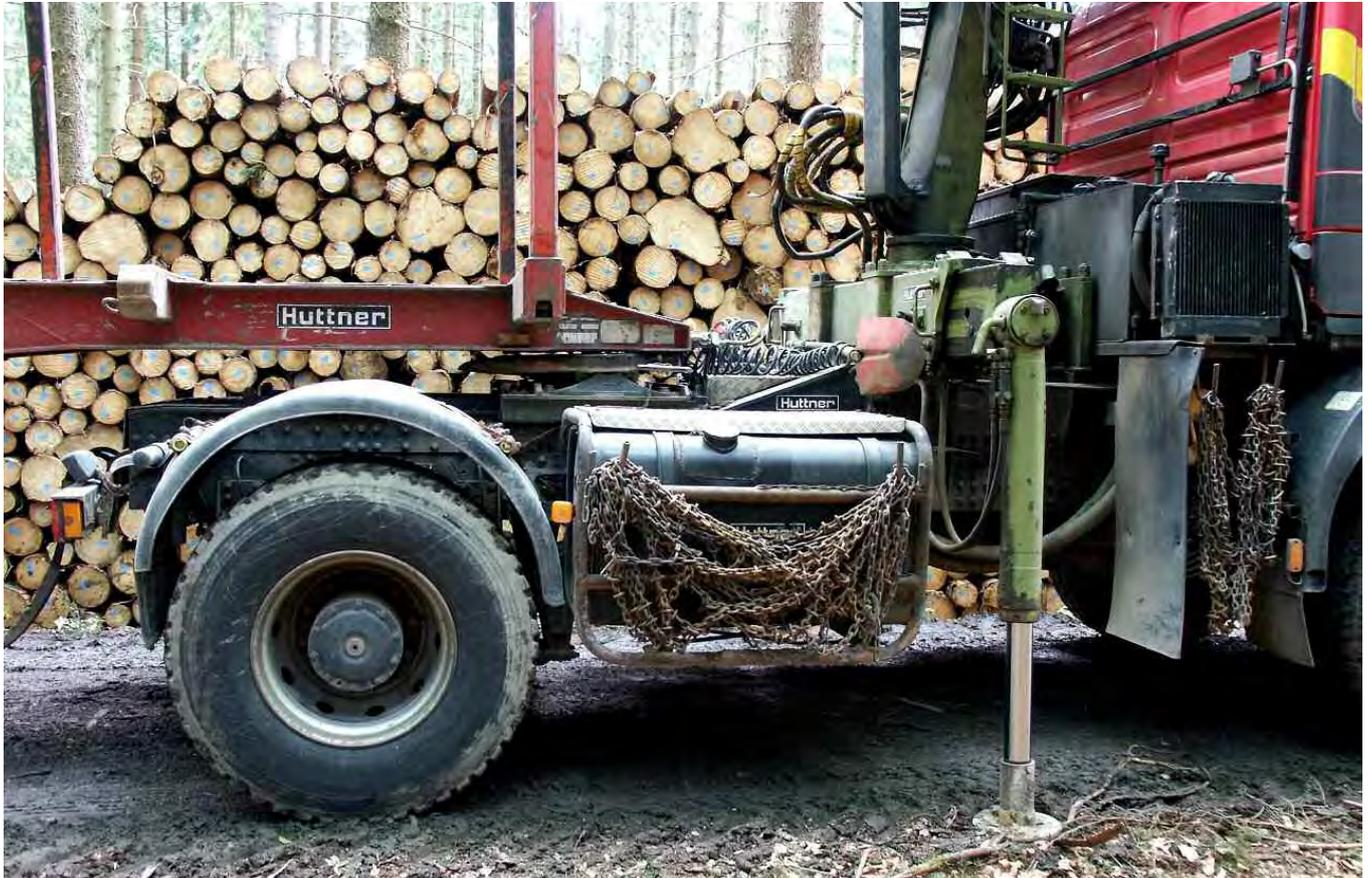
Sattelkupplung um 1,2 m hydraulisch in die Ladeposition nach vorne gefahren
