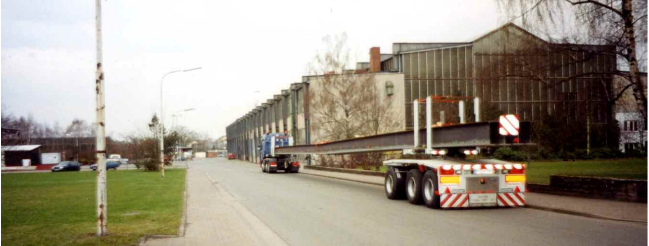
38m lange Stahlträger
